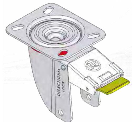
Il freno direzionale è integrato nel supporto rotante. E' idoneo per carrelli a traino manuale o carrelli a traino meccanizzato a bassa velocità (massimo 6 km/h) su pavimentazione in buone condizioni. Per facilitarne l'utilizzo, è dotato di auto inserimento nell'intaglio di direzionamento ruota presente sull'anello tenuta sfere dei supporti rotanti. Su richiesta è applicabile ai supporti tipo NL con attacco a piastra diametro 80-100-125-140/150 mm (per supporti con piastra dimensioni 100x85 mm).
