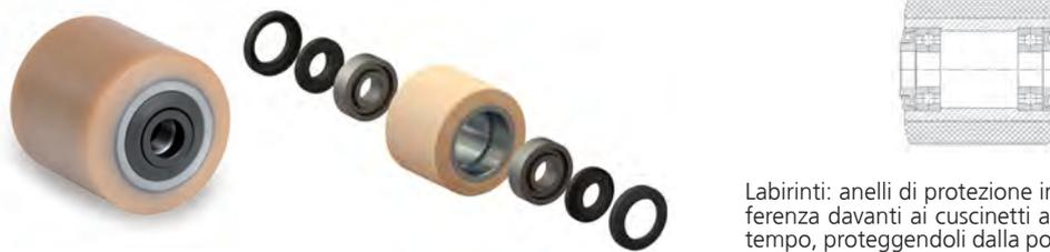
Labirinti: anelli di protezione in materiale plastico, montati ad interferenza davanti ai cuscinetti a sfere. Ne garantiscono la durata nel tempo, proteggendoli dalla polvere e dai corpi estranei che possono limitare la libertà di rotazione del rullo.
