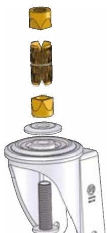
Es wird empfohlen die Schraube des Expanders mit dem angebrachten Drehmoment anzuziehen. Ein ungenügender Drehmoment könnte die Stabilität und/oder die Gesamttragkraft des Produkts beeinträchtigen.
